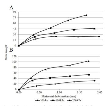
Figure 3. Shear strenght versus horizontal deformation soil submitted pressure 50, 100 and 200 kPa in the conventional tillage (A) and no-tillage (B). Figura 3. Tensão de cisalhamento versus deformação horizontal do solo submetido às pressões de 50, 100 e 200 kPa no manejo convencional (A) e plantio direto (B).
